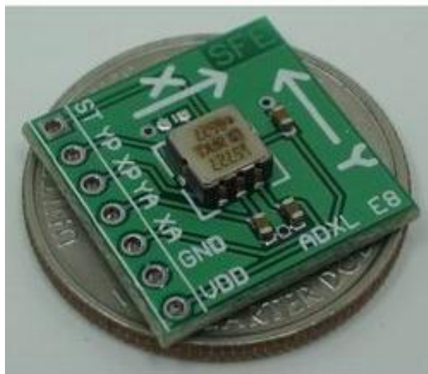
شکل ۲-۱۵: نمونه یک شتاب سنج دوماحوری ADXL
